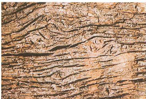
Fig. 3. Overfladeråd i egetræ. Overfladen mørner og sprækker i nogle millimeters dybde, mens træet nederunder stadig kan være frisk.
