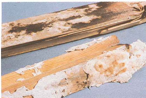
Fig. 91. Skællet Sejhat ( Lentinus lepideus ). Overflademycelium. Både myceliet, frugtlegerne og det angrebne træ har en karakteristisk lugt, der minder om perubalsam.
