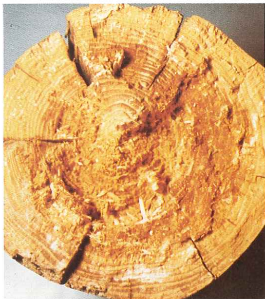
Fig. 60. Brudflade i ledningsmast angrebet af overfladeråd yderst, og Pælesvamp ( Rigidoporus vitreus ). De hvide pletter er pseudosklerotier fra Rigidoporus . \times \frac{1}{3} .
