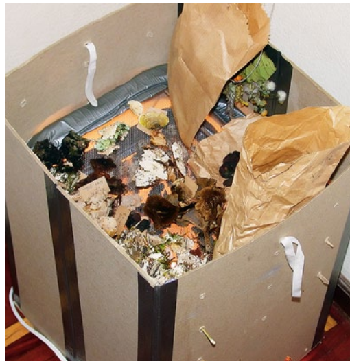
Det hjemmelavede felt-tørreapparat, der blev lavet af tykt pap og gaffatape – i bunden en lyspære som varmekilde.
